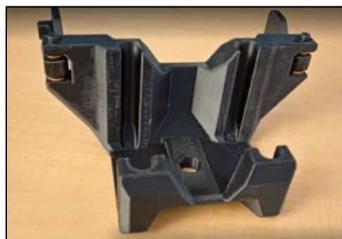
Naproti tomu 3D tištěný přípravek vpravo slouží ke stejnému účelu, ale skládá se z méně dílů a lze jej vytisknout během jediné tiskové operace.
