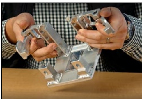
Montážní přípravek vlevo se skládá z několika dílů, které jsou k sobě přivařeny a připevněny.
